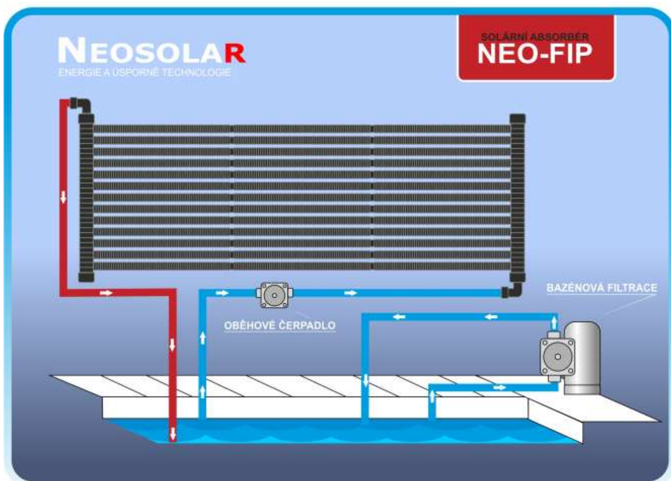
Schéma č. 2: vytvoření samostatného okruhu včetně přidavného oběhového čerpadla
